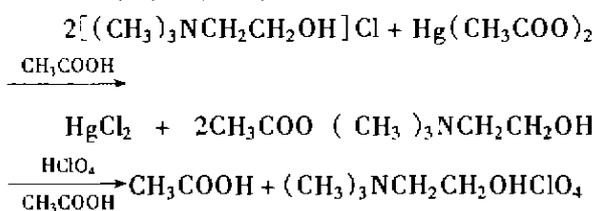
2. 分析。该方法依据的是国家标准及化工行业标准, 检测的准确度、重现性均比较好, 但在实际操作过程中我们发现, 样品中加入水溶性氯化物如 NaCl 以后, 经甲醇苯酸、水浴蒸干, 用冰醋酸溶解残渣, 明显发现有白色沉淀(NaCl)后, 用高氯酸进行滴定至终点后又很快返回紫色溶液, 继续滴至终点后又可以返回。仔细观察发现沉淀物(NaCl)在缓慢进行反应。在冰醋酸介质中, 由于酸的区分效应,  $HClO_4$  的  $K_a = 2.0 \times 10^7$ ,  $HCl$  的  $K_a = 1.3 \times 10^3$ , 高氯酸的酸性强度大于盐酸。这样 NaCl 与高氯酸是可以进行反应的, 可以被高氯酸滴定至一定终点, 这样将使得测定结果偏高。当样品中掺入可溶性氯化物(如 NaCl 或三甲胺盐酸盐)就不能测出氯化胆碱的实际含量。具体测定见表。
