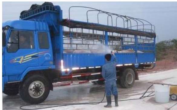
使用氧化电位水进行车辆冲洗消毒
