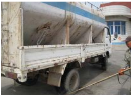
使用氧化电位水进行车辆冲洗消毒
